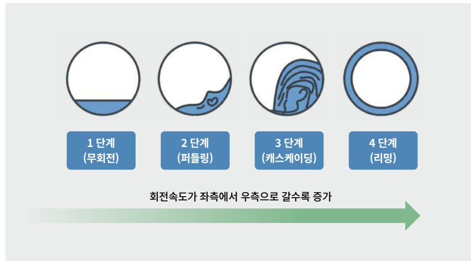
그림 10-08. 건조 실린더 내의 응축수의 유동 모드 및 실린더 회전속도에 따른 응축수의 성상변화
