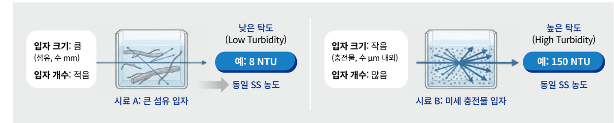
그림 08-03. 동일한 부유고형물(SS) 농도에서 입자 크기에 따른 탁도 차이
