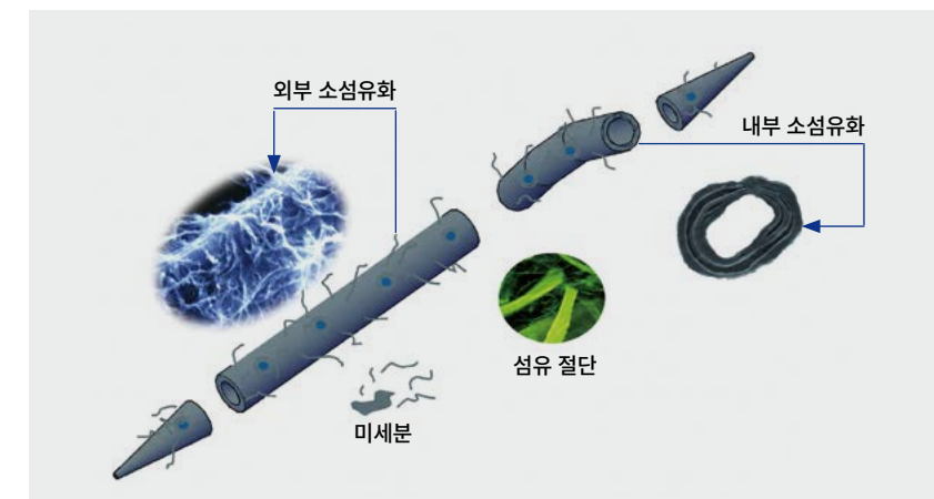
그림 04-07. 펄프 섬유에 대한 리파이닝의 주요 효과
