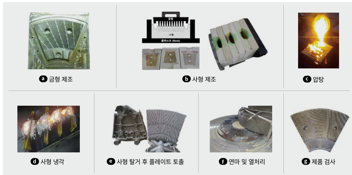
그림 04-16. 리파이너 플레이트 제조 과정
