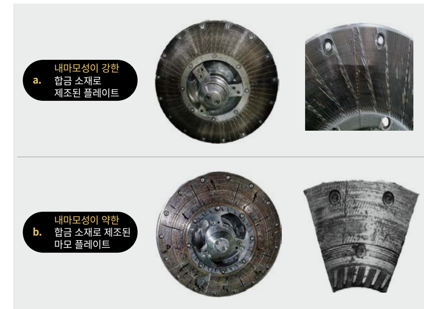
그림 04-21. 플레이트의 내마모성 정도를 비교한 사진
