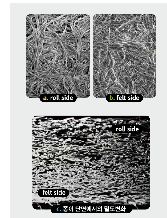
그림 09-26. 압착탈수공정에서 탈수 방향에 따른 종이구조의 양면성
