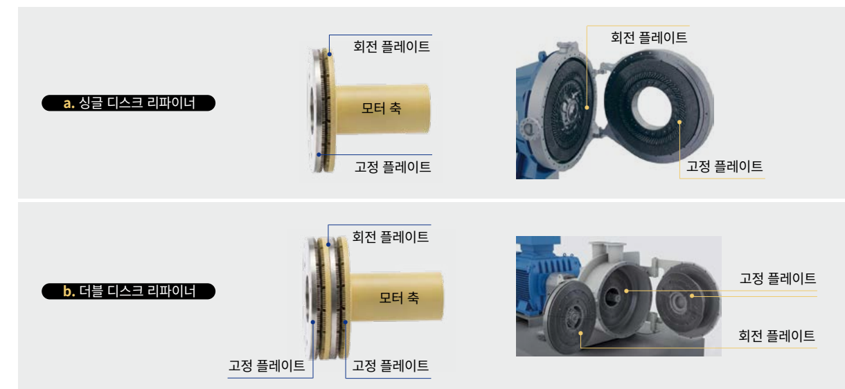
그림 04-14. 싱글 디스크 리파이너와 더블 디스크 리파이너
