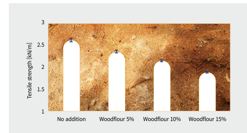
그림 09-39. 목분 스페이서 투입량 증가에 따른 제품 강도감소
