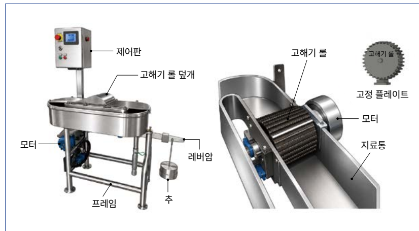
그림 04-11. Holland 고해기의 구조
