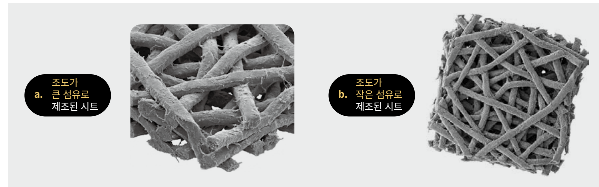
그림 04-40. 섬유 조도의 차이에 따른 종이 구조 비교 모식도
